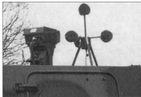
Рис. 3. Приемное устройство звукометрической станции разведки «Пилар», размещенное на крыше БРМ «Панхард»
