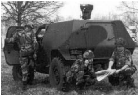
Рис. 1. Мобильный вариант лазерного комплекса SLD 400 на базе французской БРМ «Панхард»
