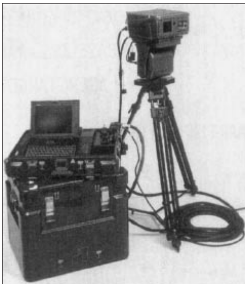
Рис. 2. Лазерный комплекс SLD 400, развернутый на грунте (переносный вариант)
