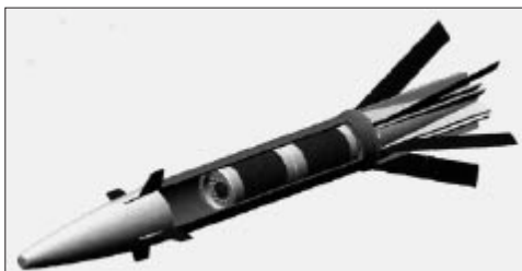
Рис. 6. Перспективный 155-мм управляемый активно-реактивный снаряд «Поул-Экс»
