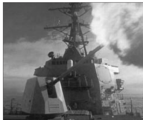
Рис. 1. 127-мм артиллерийская установка Mk45 мод. 4 на борту ЭМ УРО DDG-81 «Уинстон Черчилль» типа «Орли Бёрк»
